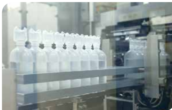
▲ 华润双鹤首家引入具有国际一流水平的“吹瓶-灌装-封口”三合一生产技术生产输液（BFS 输液）
